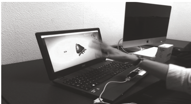
Fotografía 2. Interacción con dispositivo Leap Motion con contenido preprogramado. Fuente: elaboración propia.
